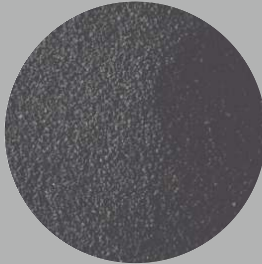
BETON PARKE İÇİN AŞINMA-YÜZEY GRANÜLÜ (SİYAH) Yüksek dayanımlı parke imalatında kullanılır.
