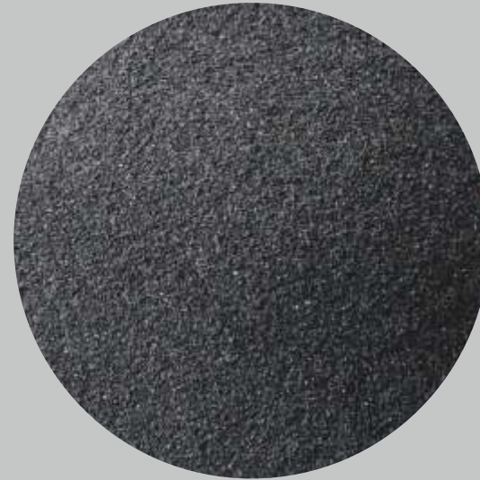
İNCE RASPA KUMU Hassas yüzeylerin temizlenmesinde kullanılan malzemedir.
