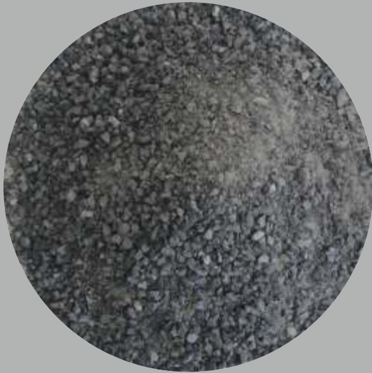
BAZALT MICIRLARI 0-5 mm - 5-13 mm - 13-19 mm. Yüksek kaliteli asfalt yapımında kullanılır.
